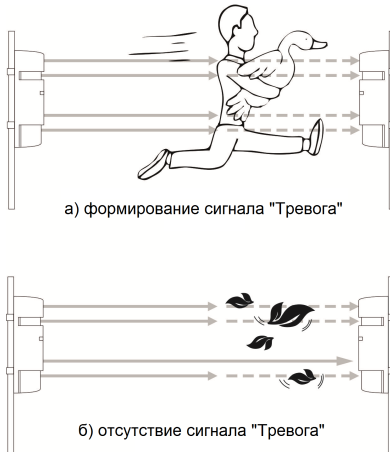
Рисунок 1.3 - Принцип действия извещателя
