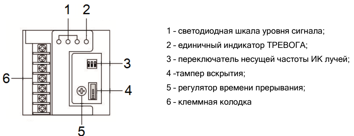
Рисунок 2.18 - Положение органов регулировки и настройки приемника
